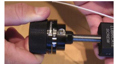
I. Drehen Sie den Knopf im Uhrzeigersinn, um Spannung aufzubringen.
