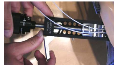
K. Fügen Sie den Kabelarretierkeil ein.
