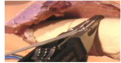
G. Lassen Sie den Kopf in die Klemme einrasten.
